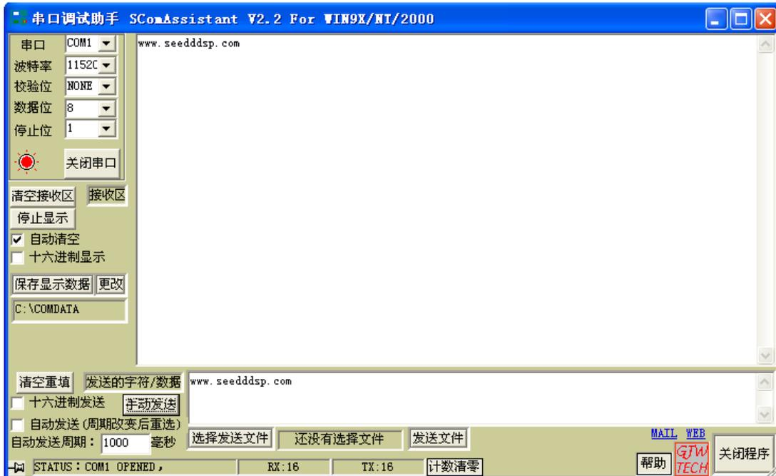
开发板端程序结果：接收到 pc 端数据，并将接收数据发给 pc，可以从上图观察到串口调试助手接收到同样的数据，证明测试成功。
